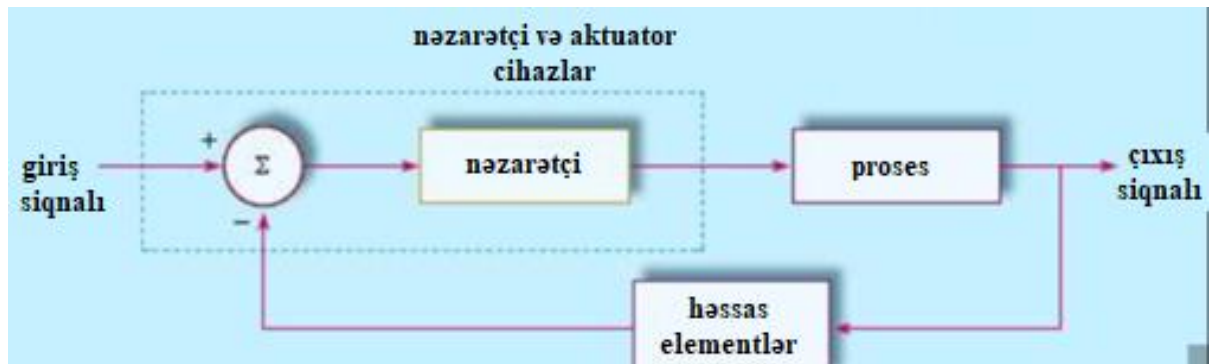
Şəkil 3.2. Qapalı dövrəli robotun idarəetmə konsepsiyası
