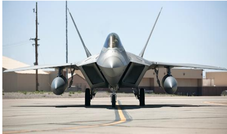
Şəkil 2.5. Ön tərəfdən F-22, quyruğun paralel xətləri və hava girişləri
