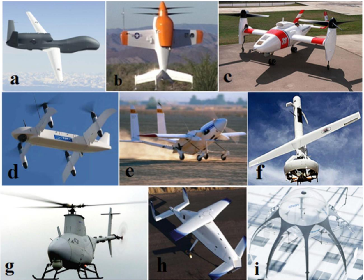
Şəkil 1.5. Müxtəlif tipli PUA-lar, (a) HTOL, (b) VTOL, (c) əyilmə-rotorlu PUA, (d) əyilmə qanadlı PUA, (e) əyilmiş gövdəli PUA, (f) kanallı fanatlı PUA, (g) helikopter (h) heli-qanad və (i) qeyri-ənənəvi PUA
