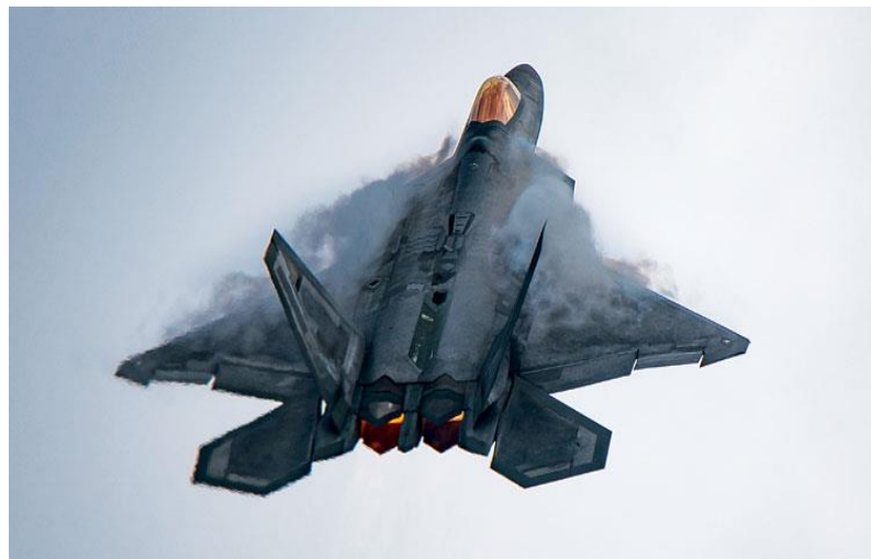
Şəkil 2.1. F -22 raptor (görünməzliyi təmin etmək üçün qanadın ön kənarı və quyruq müstəvisi eyni bucaq altında qurulur)
