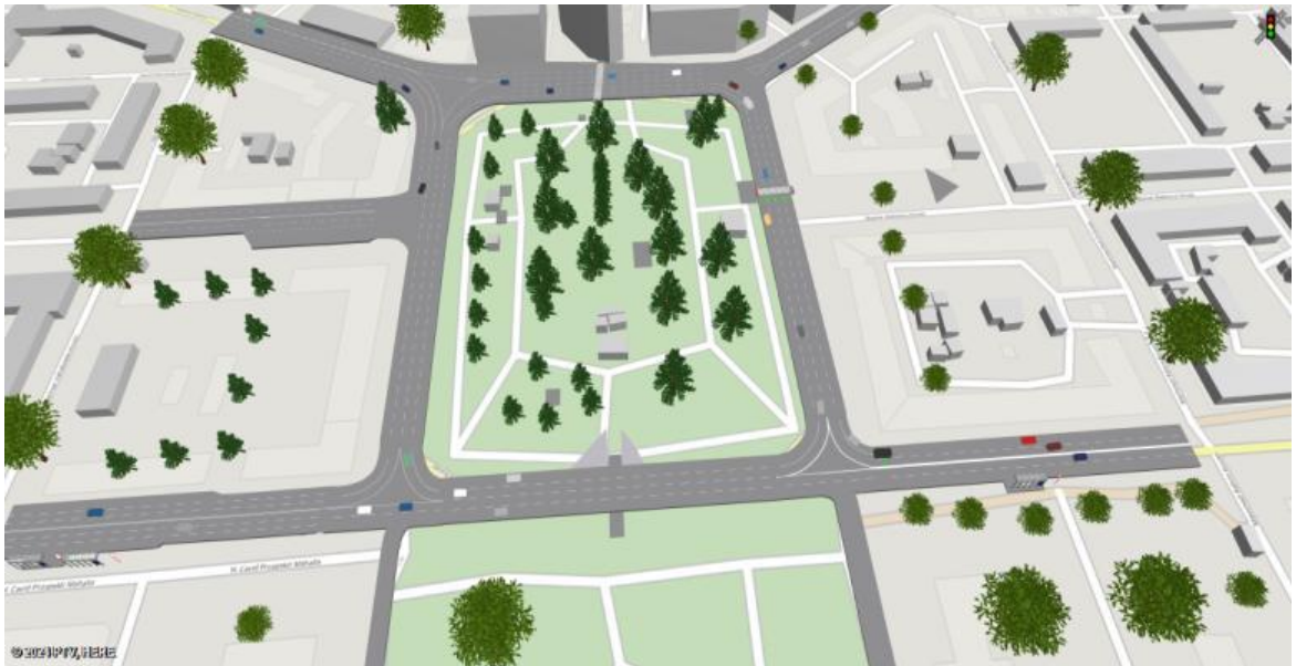
Şək. 1.2 PTV VISSIM proqramında Bakı şəhəri Yasamal rayonunda seçilmiş yolayrıcının hazırlanmış mikromodeli
