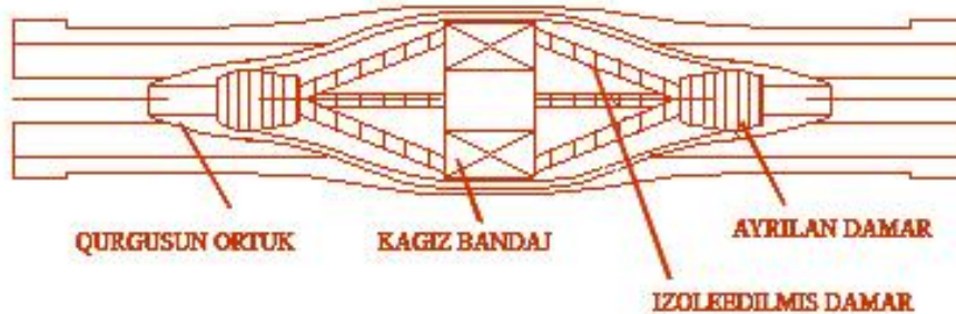
Şəkil 13.1.16. 'RAYXEM' tipli muftanın əsas konstruktiv elementləri
