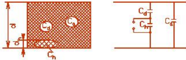
Şəkl.4.2.1. Dielektrikdə qismi boşalmaların hesablarına aid ekvivalent sxem
