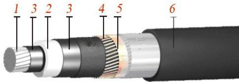
Şək.2.3 TPE (tikilmiş polietilen-XLPE) izolyasiyalı kabelin quruluşu və konstruksiya elementləri 1)keçirici damar, 2) izolyasiya, 3) yarım keçirici ekran, 4)keçirici ekran, 5) folqa sarğı, 6)xarici PVX şlanq mühafizə örtüyü.
