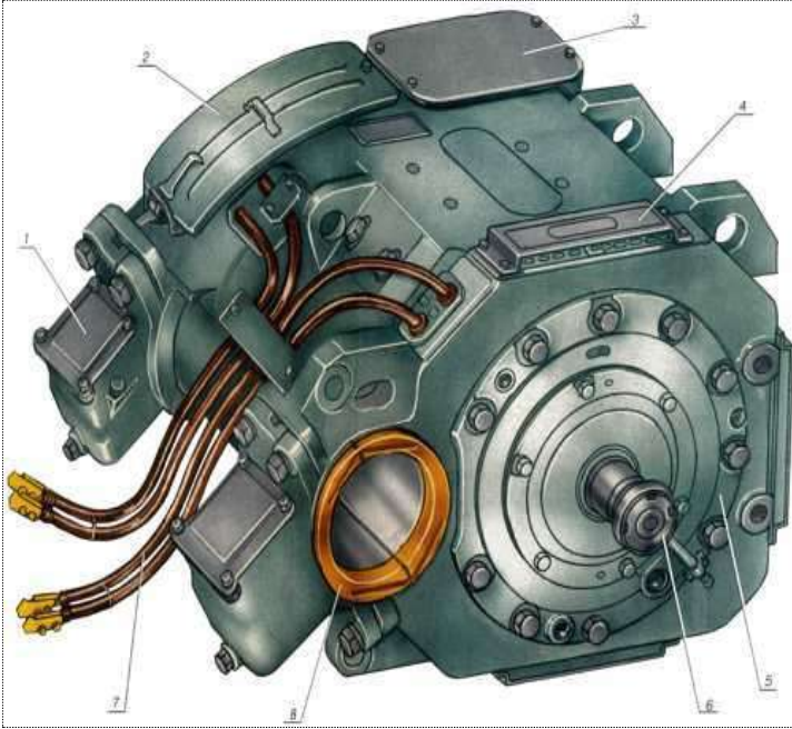
Şəkil 4.52a. ED-118 dartı elektrik mähərrikinin ümumi görünüşü: 1 – motor-ox yastığı başlığı; 2 – baxıcı lük; 3 – hava ufürücü; 4 – hava çıxışı lükü; 5 – yastıq şiti 6 – val; 7 – kabellər; 8 – motor-ox yastığınım içliyi.
