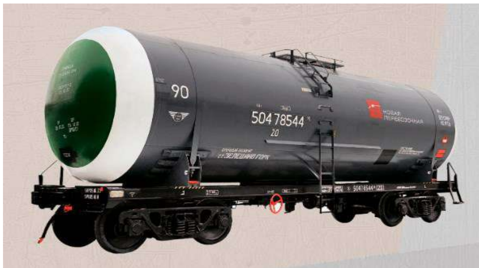
Şəkil 2.20. 15-5157-04 modeli neft məhsulları daşıyan yeni nəsəl sisterna vaqonu, xidmət müddəti 32 il.
