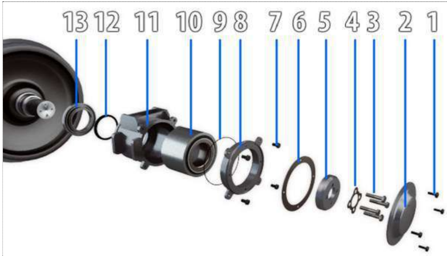
Şəkil 3.7. Vaqon buksunun yığılması. 1-M12x35 boltu, 2. Baxıcı qapaq, 3-bolt M20x60, 4-stoporlu şayba, 5- yan şaybası, 6-araqatı, 7-M20 boltu, 8- bərkidici qapaq, 9-kipləşdirici halqa, 10 CTBU 130x250x160 yastığı, 11-buks gövdəsi, 12-polimer araqatı, 13- labirint halqa.
