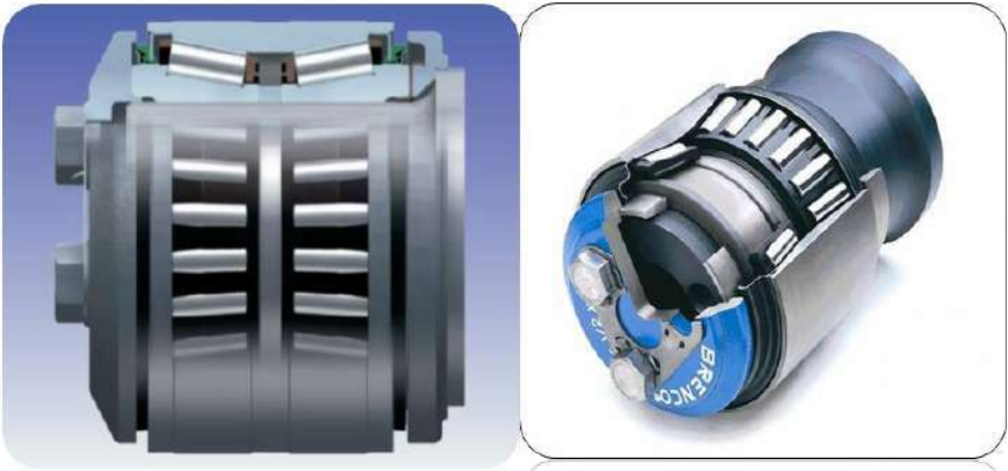
Şəkil 3.8. Kaset yastıqlı buksun ümumi görünüşü.
