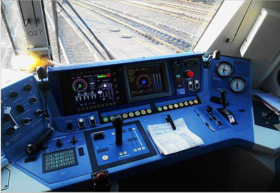
Şəkil 5.24. Yeni nəsl elektrovozun idarə etmə maşinist-kabinəsi
