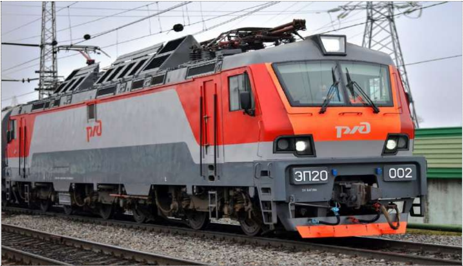
Şəkil 5.10. İki sistemli ( U=3000V , U=25000 V ) ЭП20 (2 0 -2 0 -2 0 ) seriyal sərnişin elektrovozu: dartı qüvvəsi F_k=325kN , maksimal istismar sürəti 200 km/saat.
