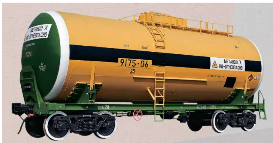
Şəkil 2.22. 15-150-05 modelli metanol daşıyan xüsusi sisterna vaqonu ( P=65 \text{ ton} , T=28,5 \text{ ton} , V_t=83,9 \text{ m}^3 , depo təmirinə qədər gedişi 210 min km, xidmət müddəti 24 il)
