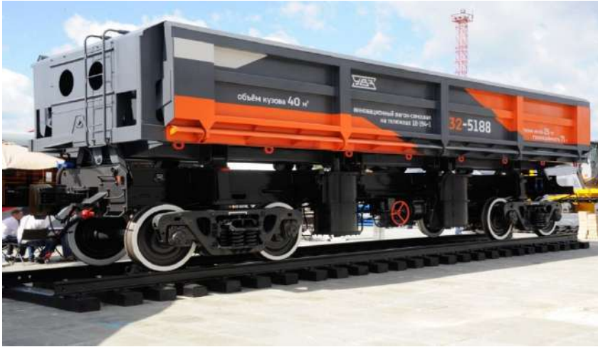
Şəkil 2.23. 18-194 modelli özüböşaldan-vaqon, q_0=25 ton.
