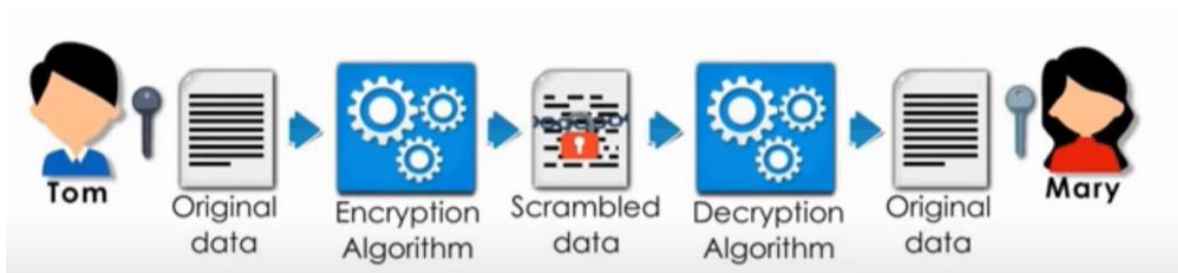
Şəkil 2.3.2 İki şəxs arasında asymmetric şifrələmə ilə məlumat transferi
